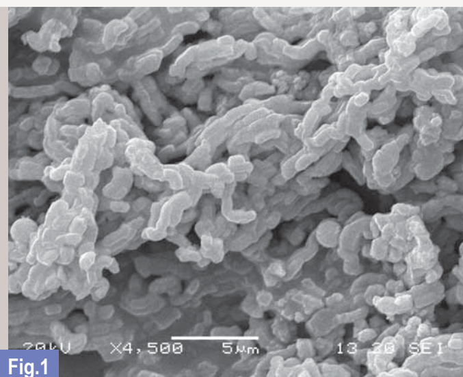
Fig.1: Immagine SEM di particelle silicee mesoporose SBA 15.
