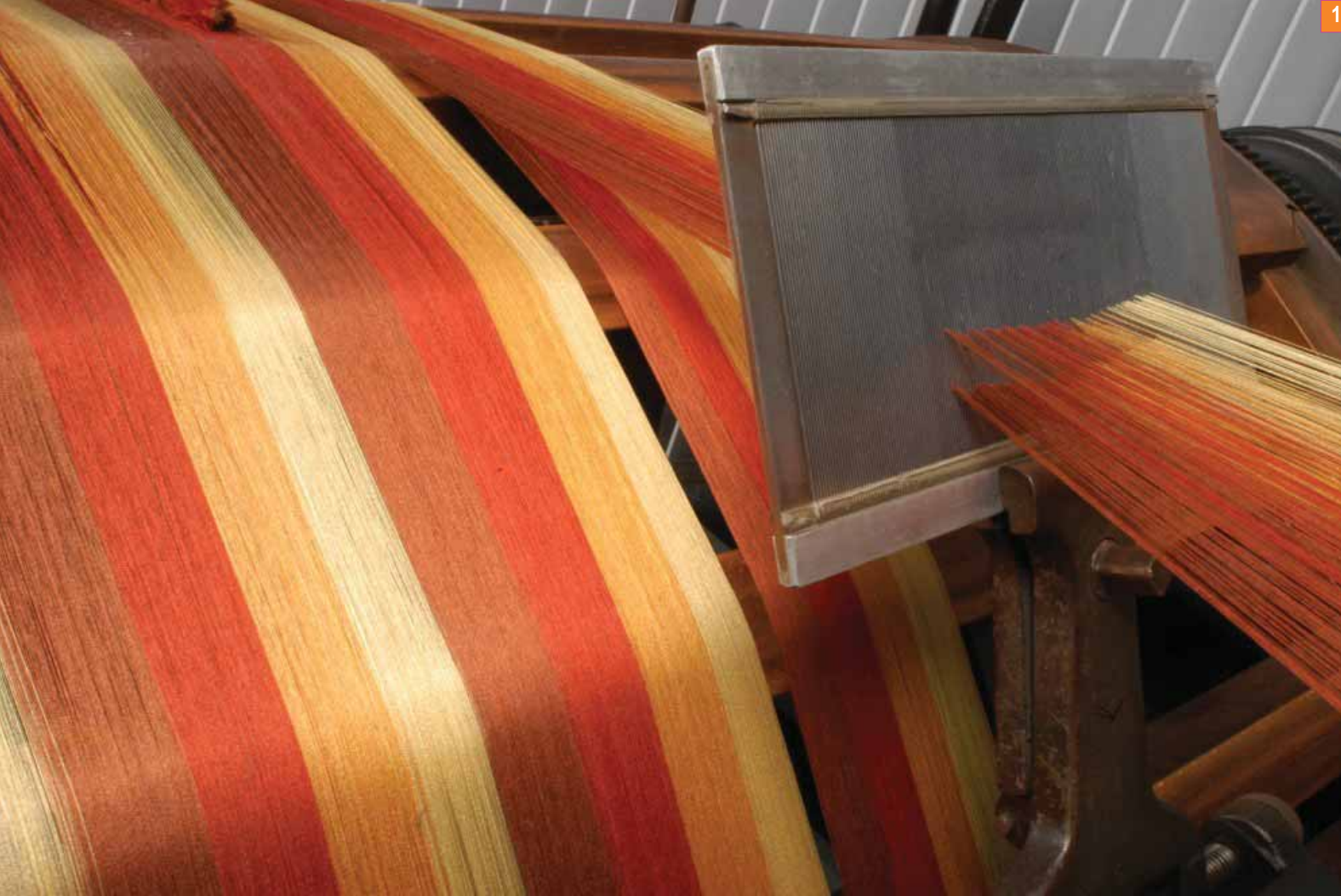
Fig.1: Preparazione alla tessitura: particolare di orditoio a sezione
